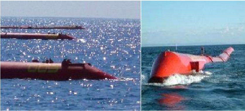
الشكل (3-5) وحدة لتوليد الكهرباء تعوم على سطح المياه
